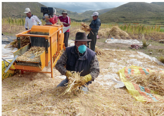
(foto A y B) Trilladoras “HERRANDINA” (modificada) y “VENCEDORA”.
