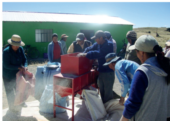
Venteo mecánico con venteadora accionada por motor.
